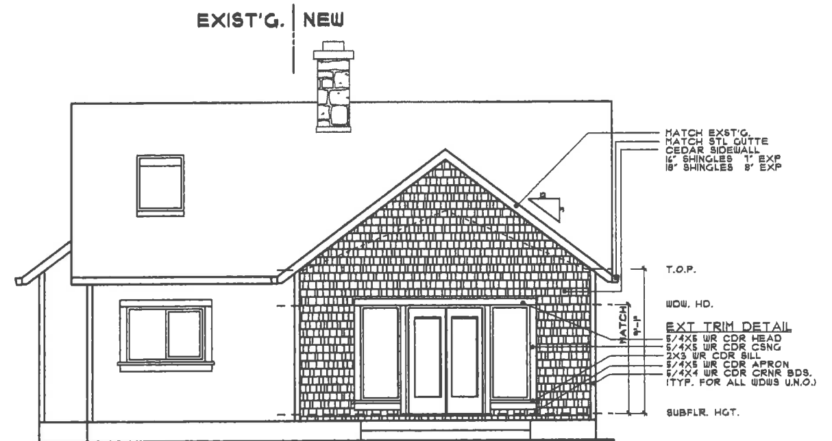
REAR ELEVATION SCALE: 1/4"=1'0"
